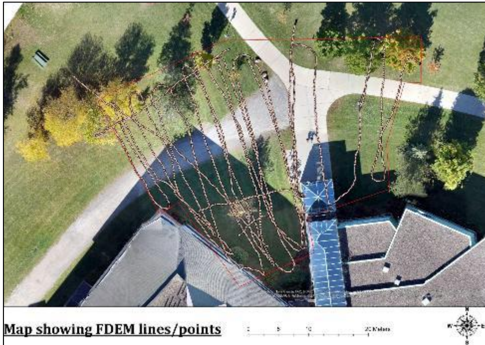
Figure 5 Points collected using the Mala mini 6L FDEM
