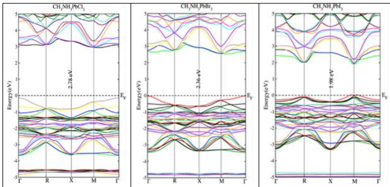
**Figure 4** Band structure of  $\text{CH}_3\text{NH}_3\text{PbCl}_3$ ,  $\text{CH}_3\text{NH}_3\text{PbBr}_3$  and  $\text{CH}_3\text{NH}_3\text{PbI}_3$  using GGA. [81]
